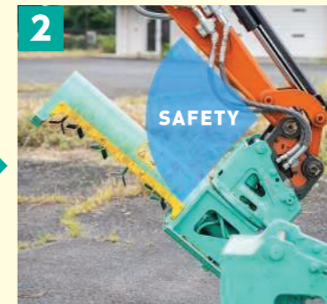
2 落下防止の角度センサーで安全
