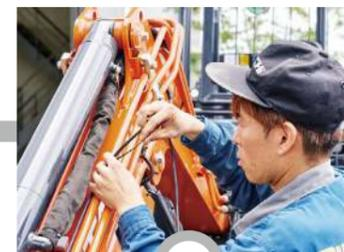
電源ケーブルのプラグをワンキャッチのソケットに差し込み、アームに電源ケーブルを沿わせて結束バンドで留める。
