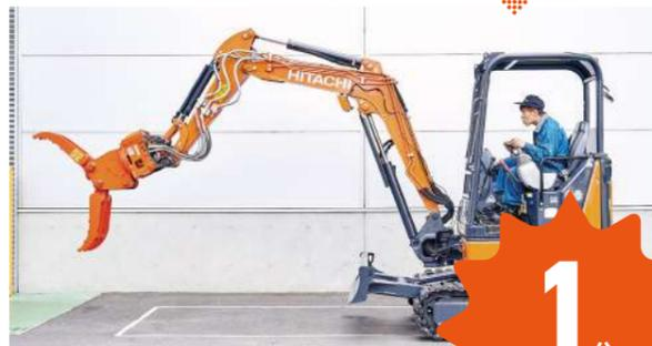
装着するやいなや、油圧回路がつながり、アタッチメントが旋回! すぐに作業に入ることができます。経験の浅いオペレーターでもカンタンに装着可能。わずか1分!
