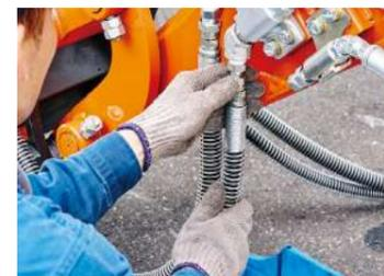
ホースの取り付け箇所をパーツクリーナーで洗浄した後、ホースを取り付ける。取り付けが完了したら、ストップバルブを開く。
