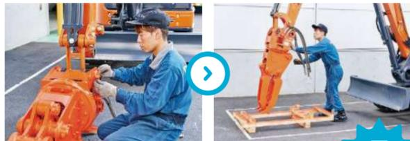
今回装着のグラスパーは「GV-32S」を使用。このクラスなら取付ピンの装着などひとりで作業が可能だが、さらに大きなクラスになると取付ピンも重く、単独作業では難しい。
