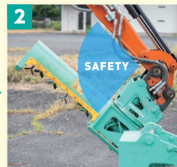
2 落下防止の角度センサーで安全
