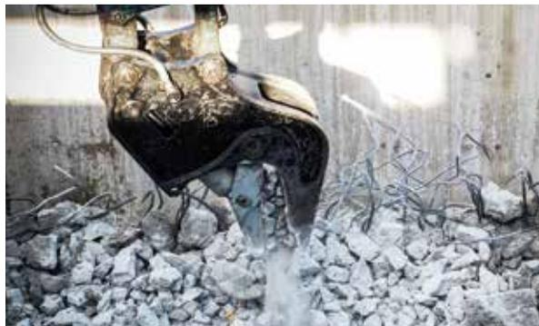
標準装備の特殊鋼ブレードと鉄筋をつかめるアーム形状で、分別収集が楽にできます。圧砕シリンダロッドを内部に格納することで、ロッド部の損傷を防止しています。
