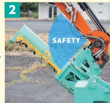
2 落下防止の角度センサーで安全
