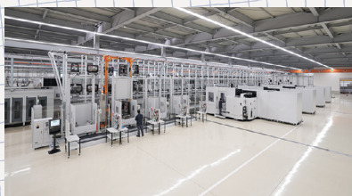
90パレットのラックがついた加工機など省人化設備を初導入した大山工場。
