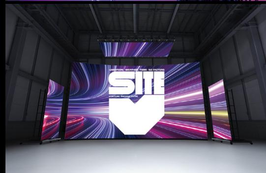
メインのスクリーンに加え、天井と左右にもLEDを使用することで、よりリアルな撮影が可能になる。車の走行シーンの撮影ではボディやフロントガラスにも背景が映り込むので、グリーンバック撮影での合成では再現できないものが撮影可能だ。
