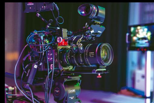
カメラの付属品から出る赤い光を天井のマーカーが認識してカメラ位置を特定。サーバー側のシステムと連動する。小さな箱のようなこの付属品がインカメラVFXを支えているのだ。
